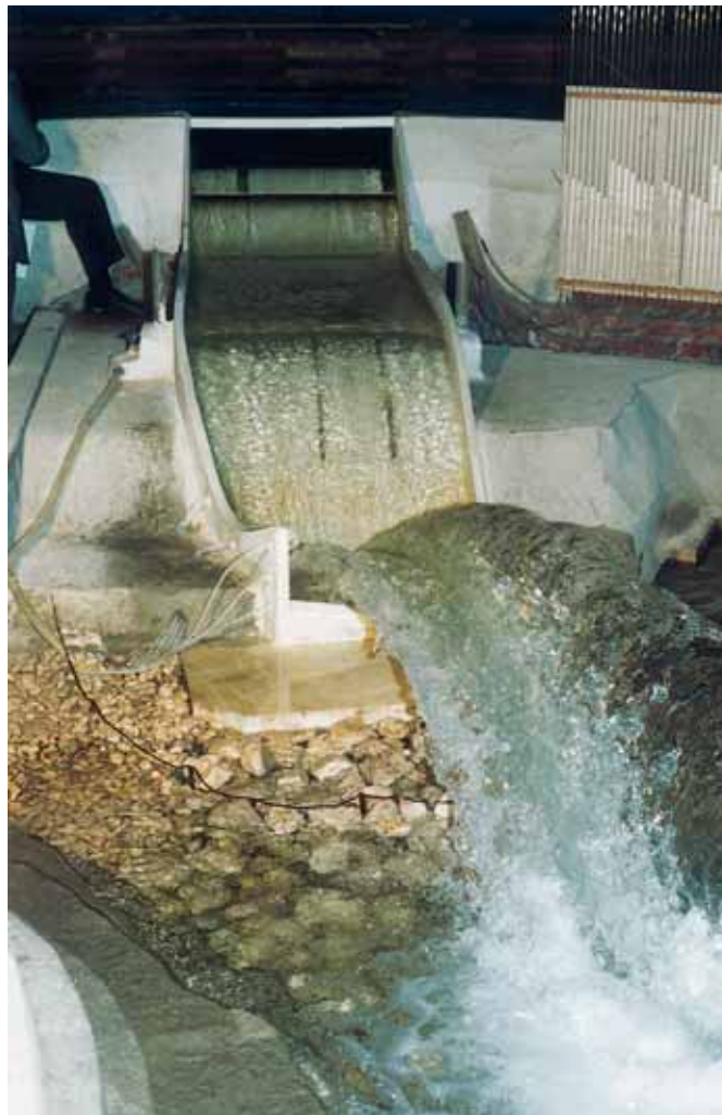
Ensayo en modelo reducido del aliviadero y las válvulas del estanque de regulación
